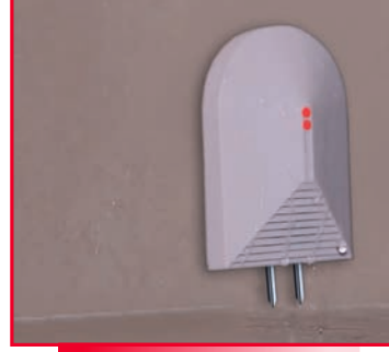
Su Baskını Alarmı
